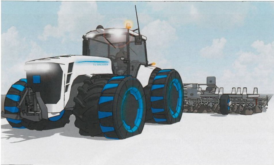
Die Zwillingsräder falten sich bei der Arbeit auf dem Acker aus.
