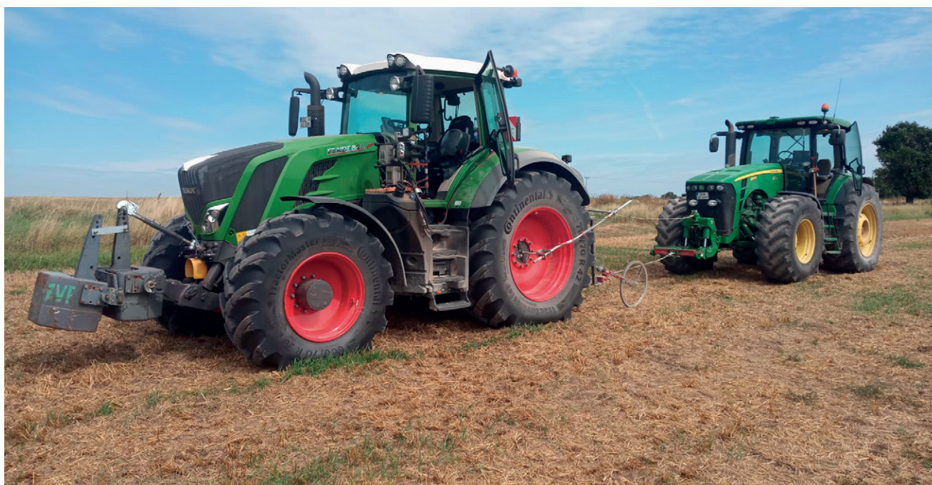
Bild 4: Traktorgespann im Feldtest mit dem Fendt 828 Vario als Versuchstraktor und dem John Deere 8245R als Bremstraktor
